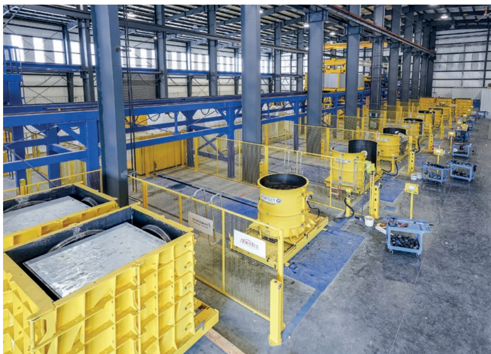
Liczne stacje robocze zapewniają płynność procesu produkcji niezależnie od różnych czasów potrzebnych do zbrojenia form odlewniczych.
