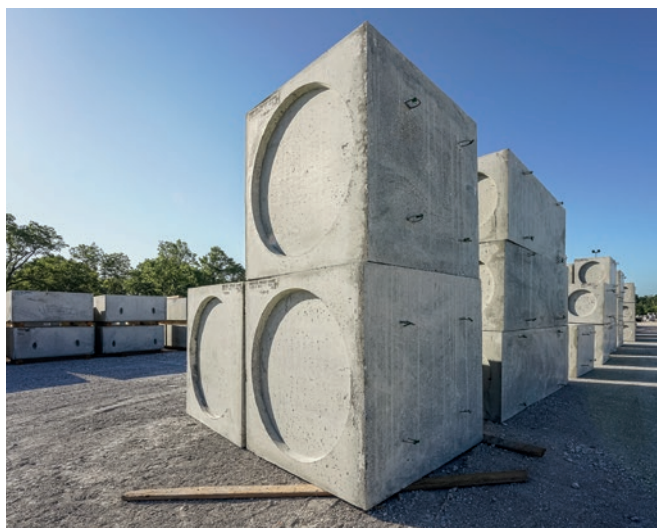
Poza monolitycznymi podstawami studni Perfect, ustandaryzowane elementy prostokątne są także produkowane w tym samym zakładzie.
