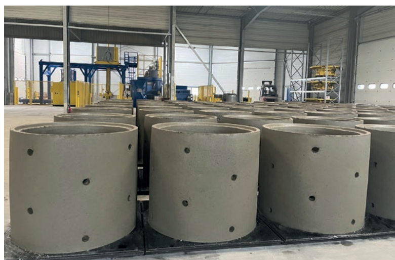
Optymalne usytuowanie strefy dojrzewania (tutaj kręgi z otworami drenażowymi) na terenie hali pomiędzy maszyną produkcyjną a systemem paletyzacji.
