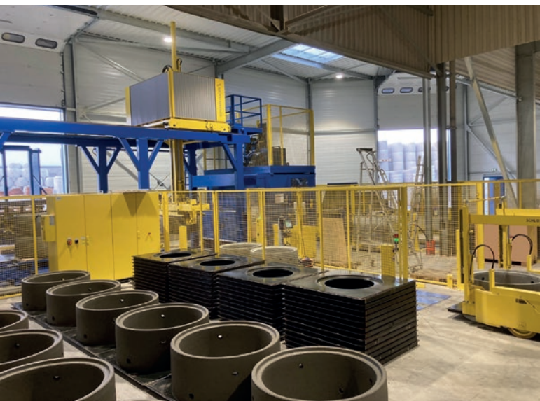
Widok systemu depaletyzacji w nowej części hali.
