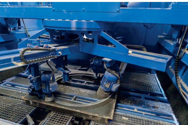
Stacja czyszczenia dolnych podkładów wraz z bezropryskowym systemem smarowania są kluczowymi cechami systemów paletyzacji Schlüsselbauer.
