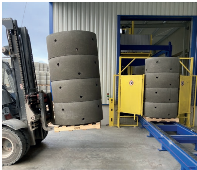
Transport gotowych wyrobów ułożonych na paletcie. Przenośnik wywozowy został umiejscowiony wzdłuż budynku, pod zadaszeniem w obszarze chronionym przy zewnętrznej powierzchni magazynowej.
