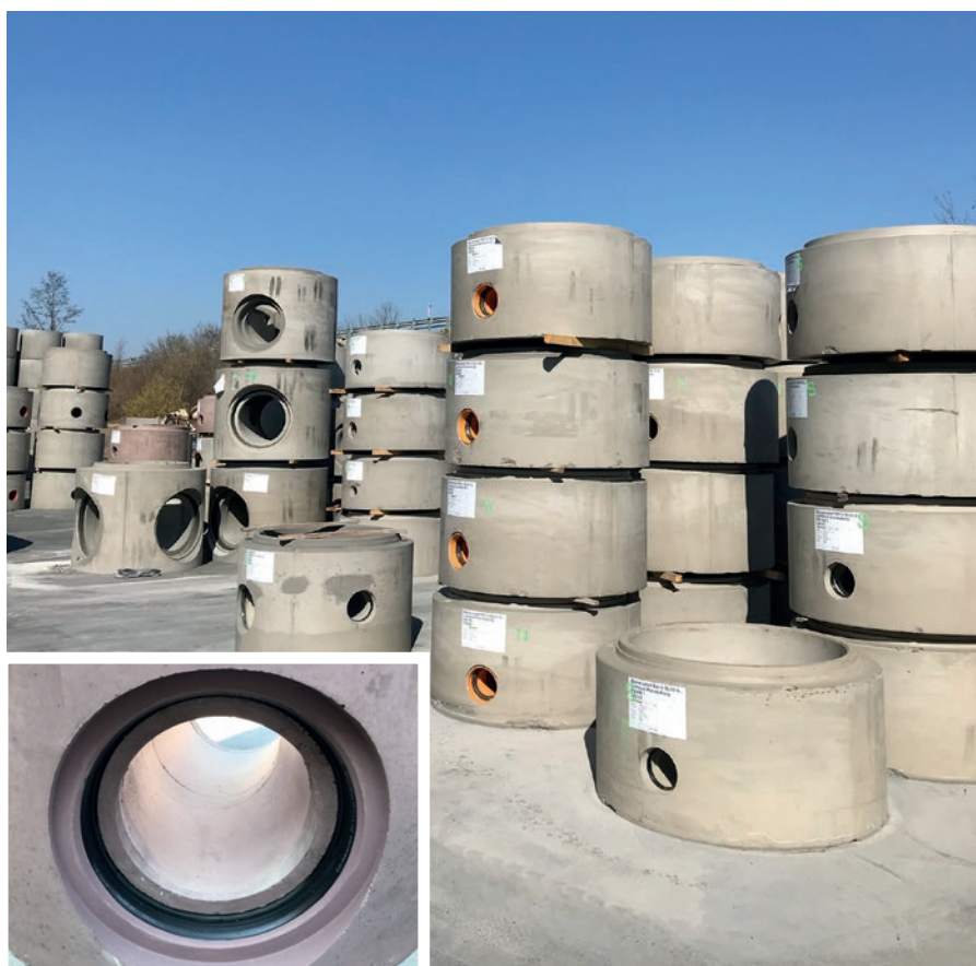
Przyłącza rurowe z zintegrowanymi uszczelnkami to kluczowy element ofensywy jakościowej HABA-Beton.
