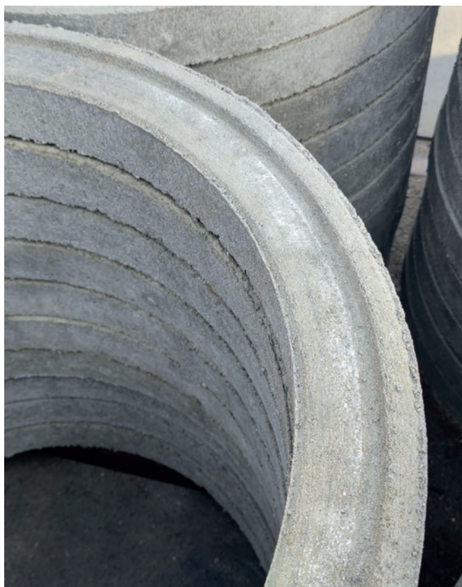
Produkcja pierścieni z falcem bez zastosowania podkładów dolnych.
