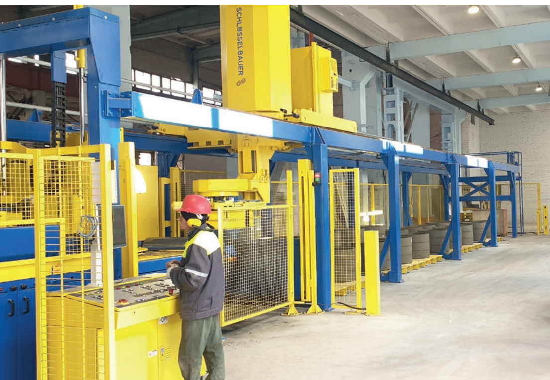
System produkcyjny Ringmaster od Schlüsselbauer Technology w Kauno Gelžbetonis.
