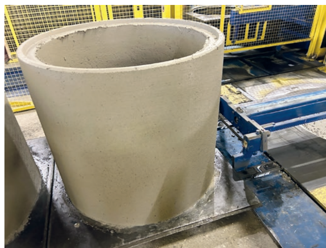
Świeży wyrób wypychany jest z maszyny na podkładzie.
