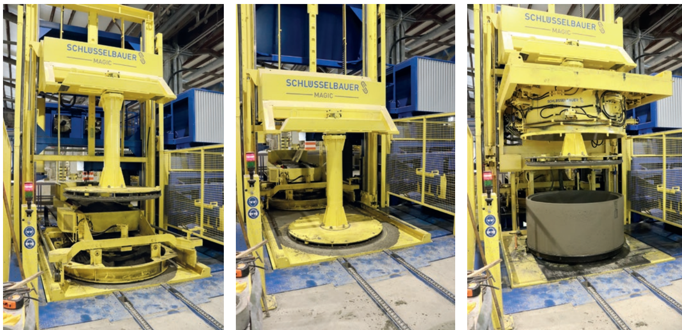
Napełnianie formy, proces wibroprasowania oraz wyprowadzanie produktu z maszyny są w pełni zautomatyzowane.
