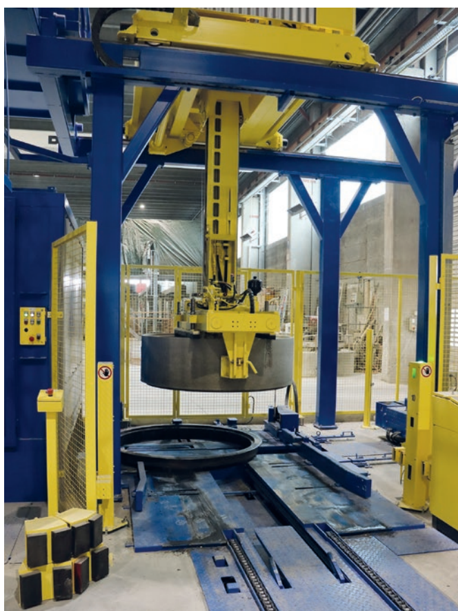
Podniesienie wyrobu przez manipulator uwalnia podkład, który jest wsuwany do stacji czyszczenia.
