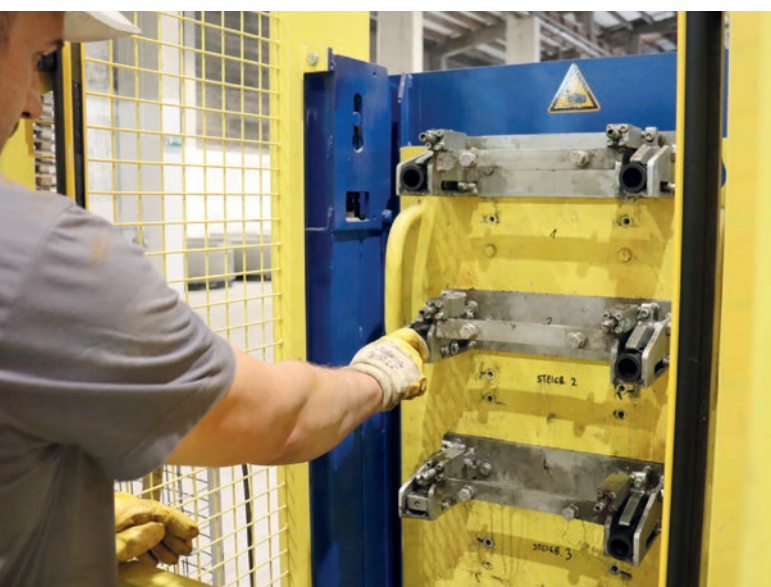
Wkładanie do uchwytu podajnika Stepmaster dybli do opcjonalnego montażu stopni.
