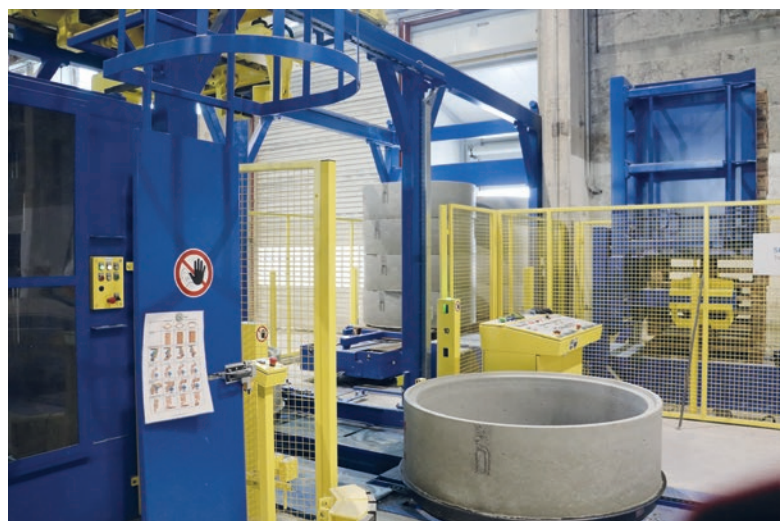
Maksymalna wysokość sztaplowania wyrobów wynosi 2 000 mm; w tle widoczne są cztery kręgi o wysokości 500 mm każdy.
