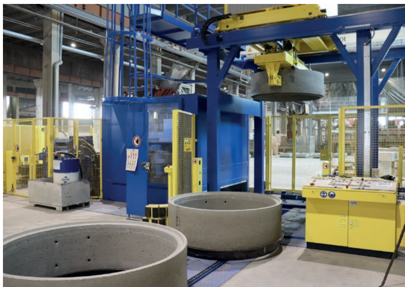
Stacja depaletyzacji oraz stacje czyszczenia i oliwienia podkładów.
