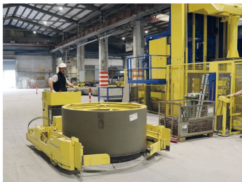
Wózek elektryczny do transportu świeżych i dojrzałych wyrobów.
