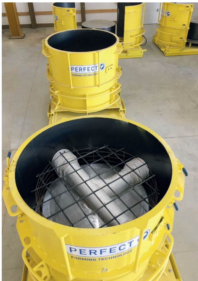
Perfect Forming Technology - termin ten odnosi się do zoptymalizowanych przez Schlüsselbauer Technology form odlewniczych do produkcji wysokiej jakości elementów betonowych.
