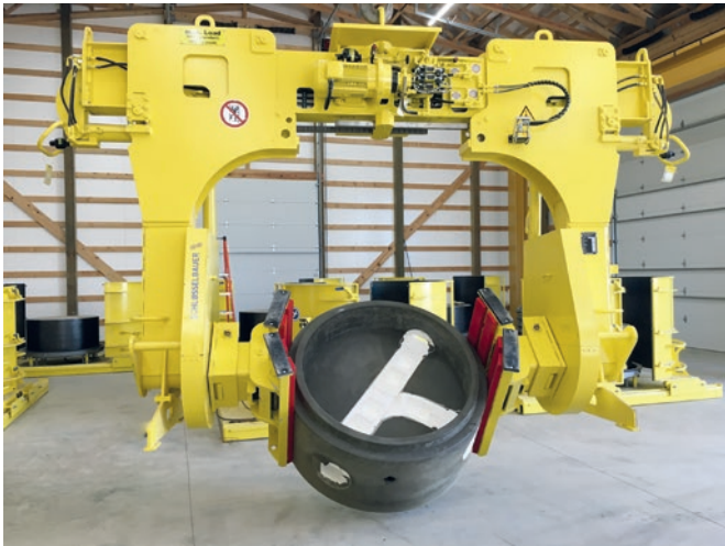
Precast Supply wykorzystuje hydrauliczną obrotnicę do bezpiecznego rozformowywania i obracania wyrobów.
