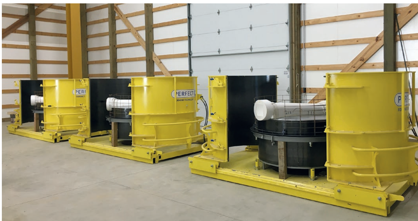
Uzbrojone formy odlewnicze z negatywami kinet EPS są gotowe do zalania betonem samozagęszczalnym.
