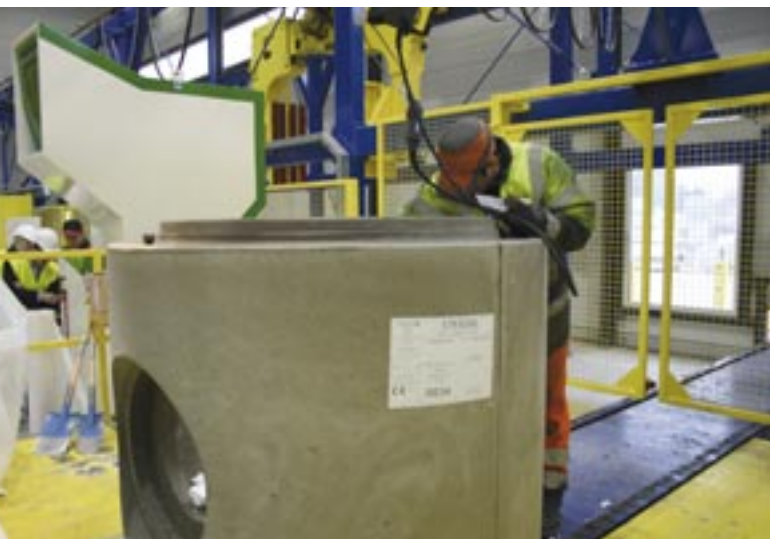
Wyjmowanie i recykling modelu kinety.
