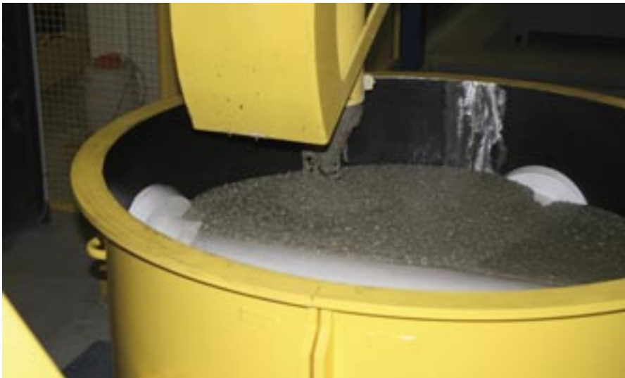
Głowica dozująca pozwala na optymalne zalewanie formy.
