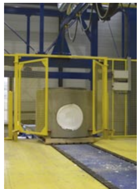
...i po umieszczenie na palecie przenośnik dostarcza je na miejsce ostatniej operacji, czyli usunięcia modelu kinety.
