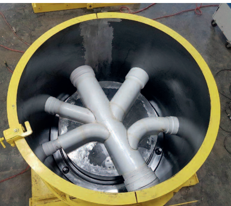
Efektywny system produkcji indywidualnych podstaw studni: negatyw kinety z kształtek EPS.
