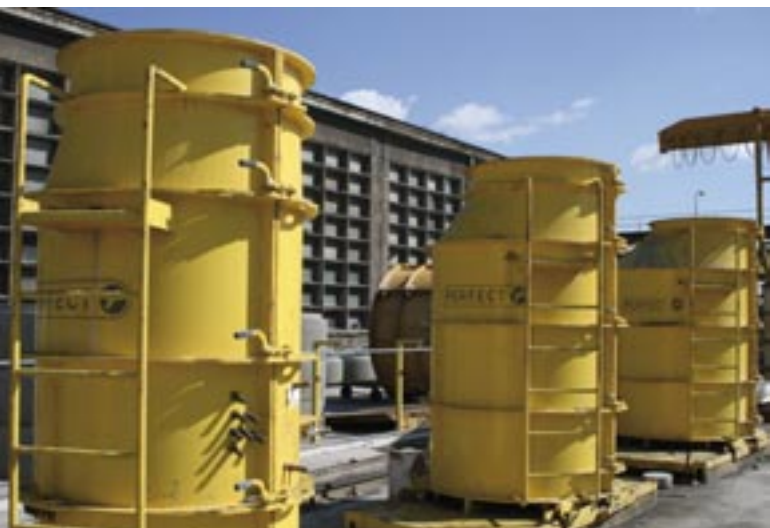
Trzy nowe formy do produkcji kręgozwęzek o wysokości do 2 350 mm i średnicach DN 1000, DN 1200 i DN 1500.
