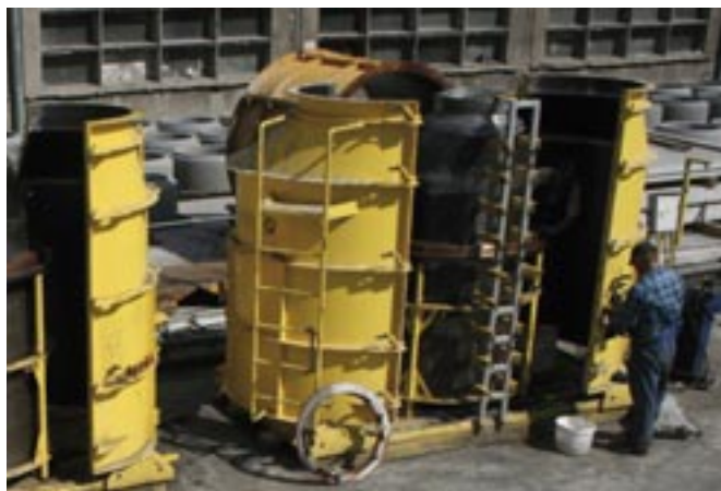
Specjalny szablon umożliwia dokładne umiejscowienie dybli na szerokie szczeble włazowe.
