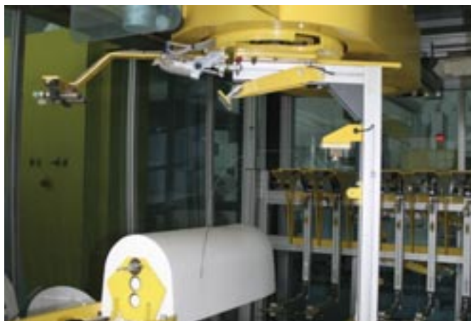
Poszczególne elementy modelu kinety wycinane są z twardego styropianu przy pomocy nowoczesnych maszyn (na zdjęciu wycinarka 3 D).
