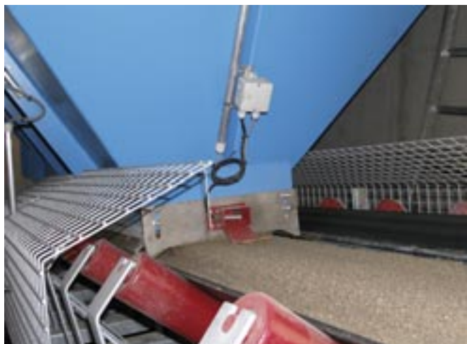
Zaletą taśmy wyładunkowej jest jej cicha praca i równomierne wynoszenie materiału.
