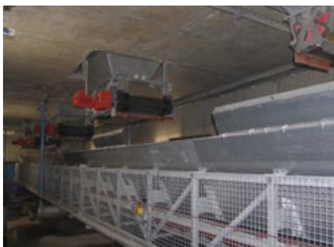
Poszczególne rodzaje kruszywa są za pośrednictwem taśm dozujących sumarycznie ważone na wadze taśmowej.
