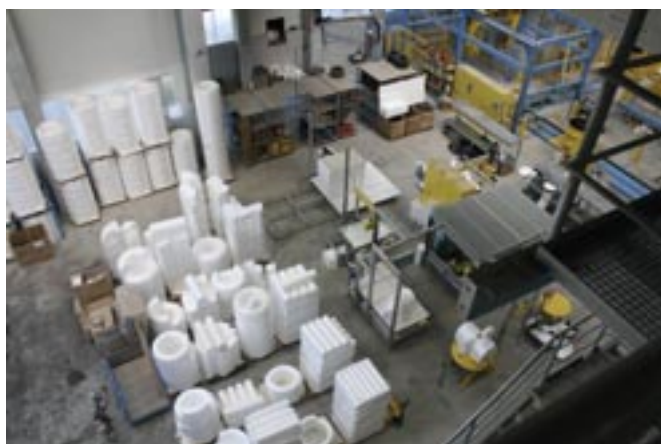
Produkcja poszczególnych elementów otworowych z EPS odbywa się przy użyciu nowoczesnej techniki wycinania.
