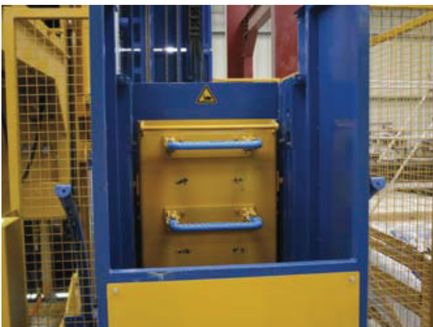
Automat zasilający formy w szczelbi złączowe nosi nazwę Stepmaster.
