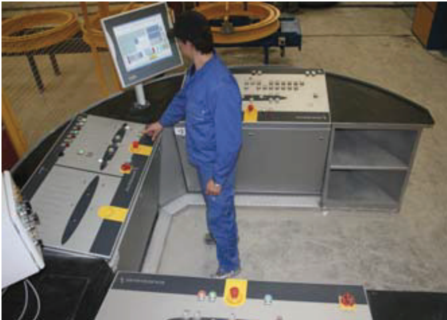
Dzięki wysokiej automatyzacji tylko jeden pracownik steruje całym procesem technologicznym: od węzła betoniarskiego aż do wywozu wyrobów poza halę produkcyjną.
