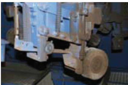
Szczotki stalowe usuwają pozostałości betonu z pierścieni dolnych.
