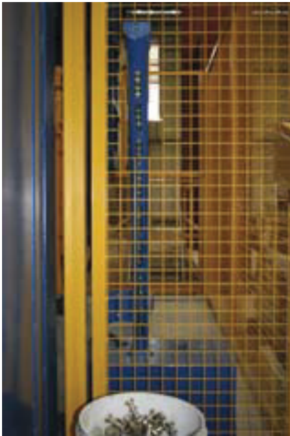
Nowość w prefabrykacji betonowej: Magazyny kotw zawierające ok. 25 sztuk po każdej stronie.
