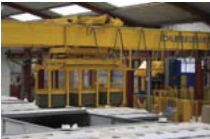
Składowanie świeżych wyrobów w komorach dojrzewania.
