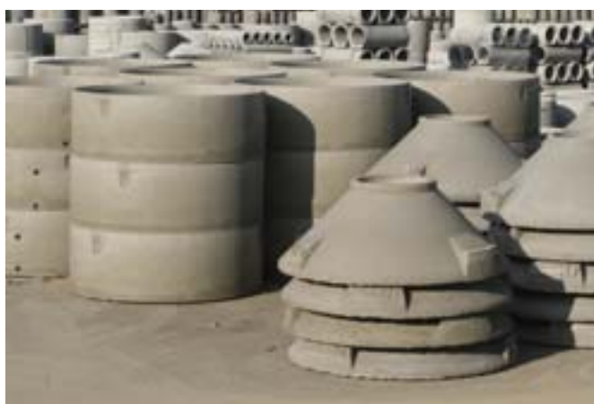
Wyroby z maszyny MAGIC 2500 w magazynie firmy Eurobeton w Chvaleticach: kręgi drenażowe, zwężki.
