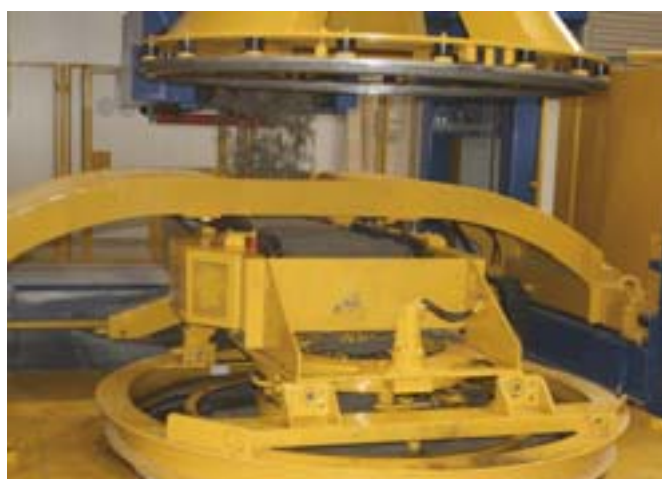
Na potrzeby maszyny MAGIC 2500 uruchomiono nowy węzeł betoniarski i transport. Na zdjęciu szybki zasyp formy.
