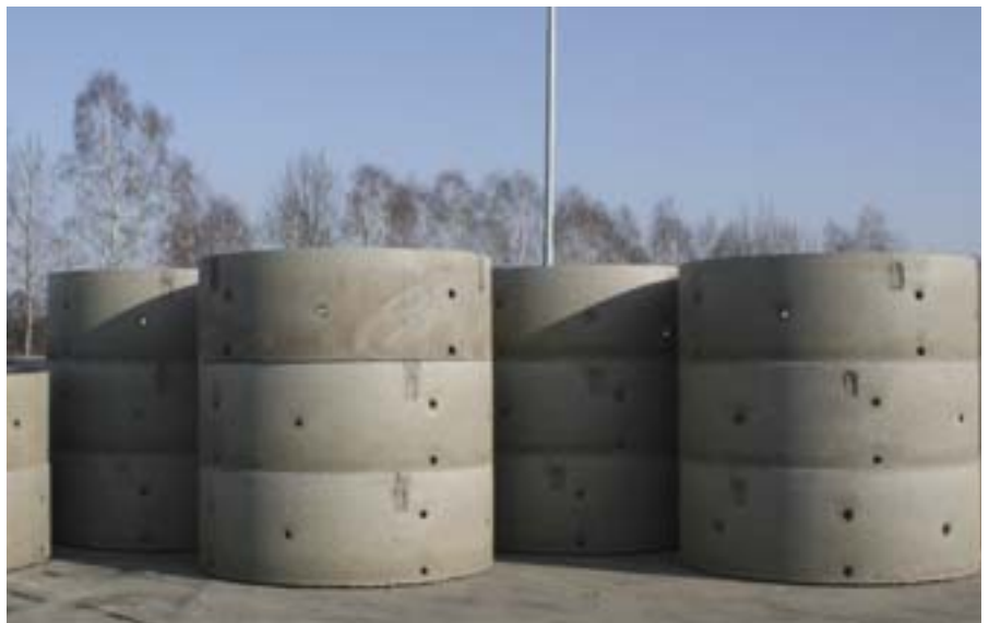
Kręgi drenażowe na placu magazynowym.
