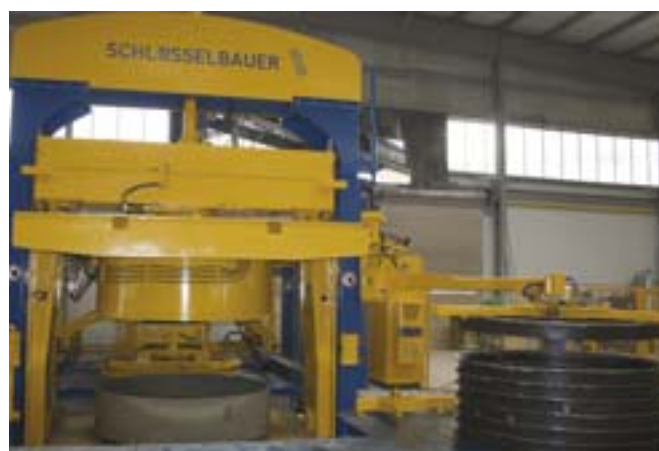
Maszyna MAGIC 2500 produkuje prefabrykaty do średnicy zewnętrznej 2 700 mm.
