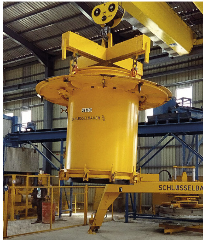
Wprowadzenie uzbrojonej formy do systemu produkcyjnego Exact XL.
