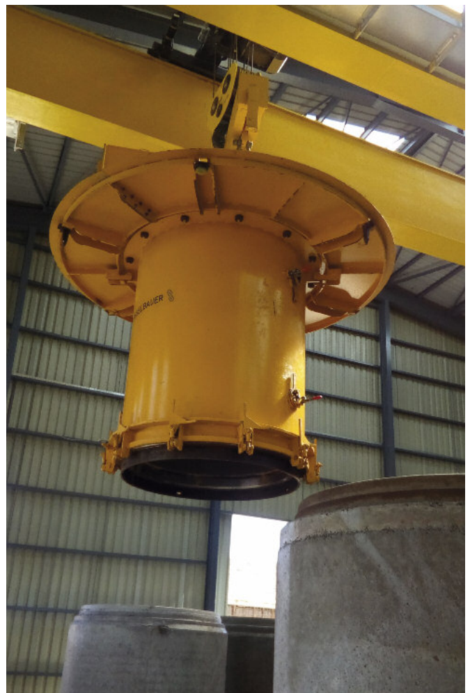
Świeżo wyprodukowane rury transportowane są za pomocą suwnicy do strefy dojrzewania.
