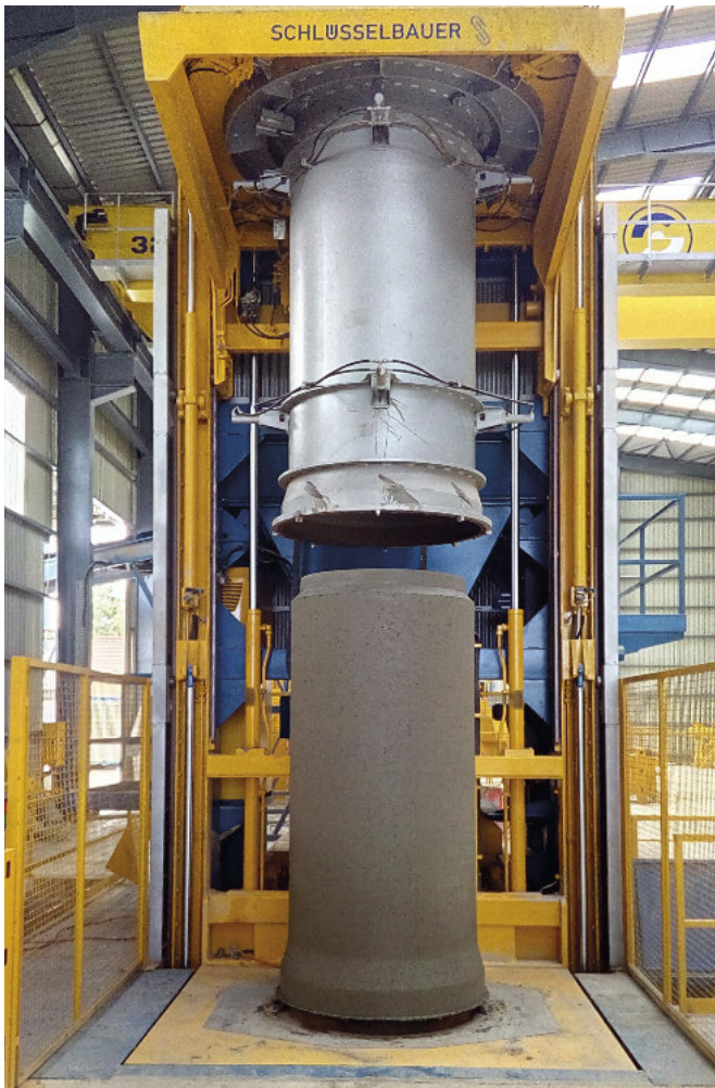
Produkcja rury kielichowej DN800 na maszynie Precise dostarczonej przez Schlüsselbauer Technology.
