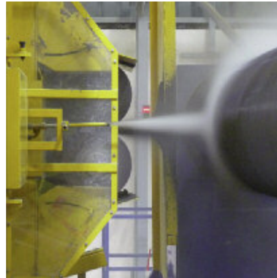
W ostatniej fazie produkcji na rurę zostaje nałożona zewnętrzna warstwa ochronna z betonu metodą wirowania.
