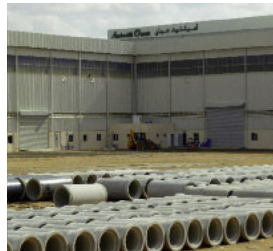
Poza betonowymi rurami ciśnieniowymi będą także produkowane rury zbrojone od DN 300 do DN 1800 oraz rury przeciskowe.
