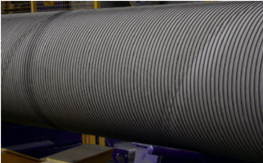
Parametry wytrzymałościowe danej rury ciśnieniowej i przewidywane warunki jej pracy definiują grubość, wstępne naprężenie i skok zwoju drutu.
