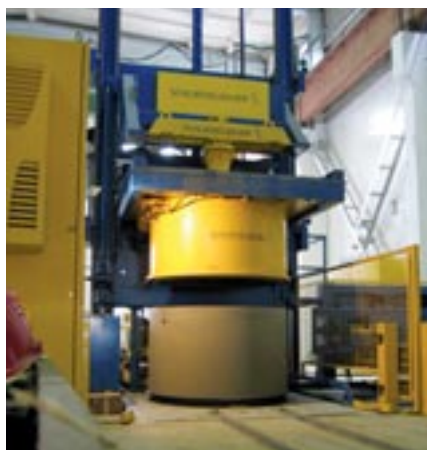
Produkcja pokryw i ich transport za pomocą automatycznego manipulatora sztaplującego zabudowanego przy maszynie Ringmaster
