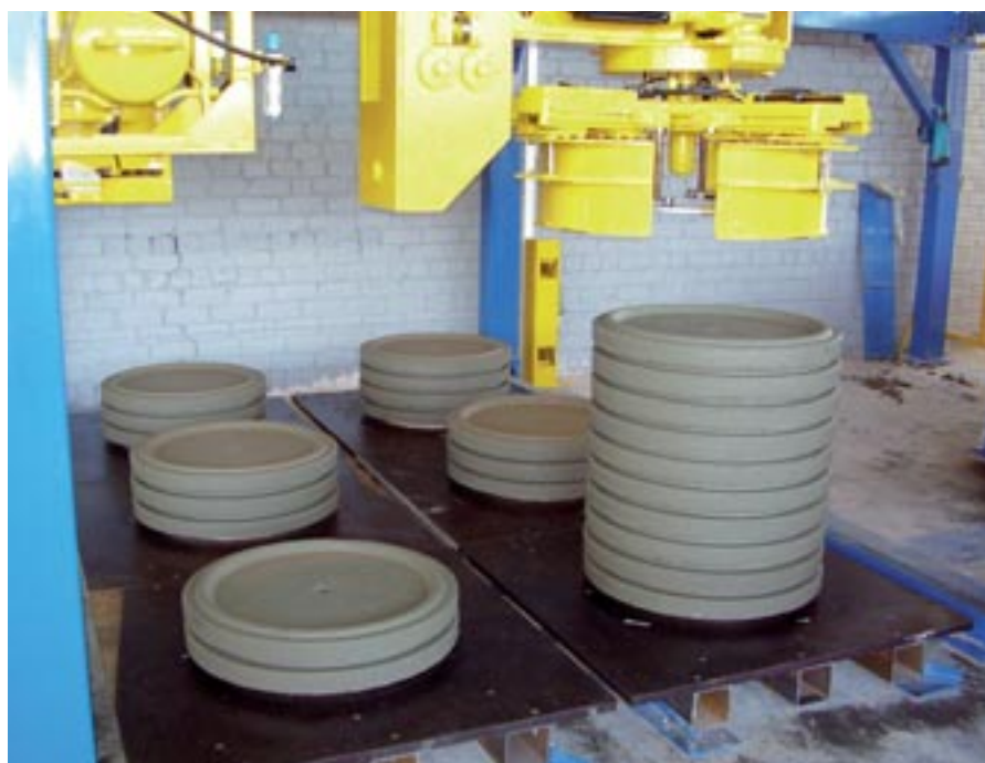
Produkcja pokryw i ich transport za pomocą automatycznego manipulatora sztaplującego zabudowanego przy maszynie Ringmaster
