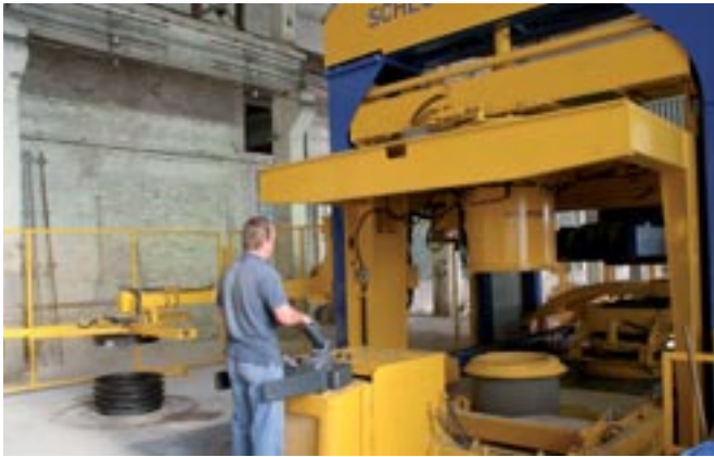
Firma Marijampolės Gelzbetonis. Odwożenie kręgu betonowego od maszyny Magic.
