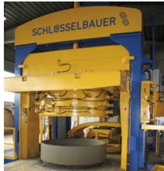
Takt produkcyjny wielkogabarytowych elementów o różnych wysokościach na maszynie Magic2500 jest bardzo krótki.
