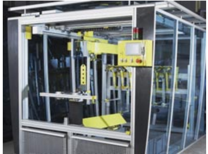
Wycinarki kształtek styropianowych stosowane do produkcji modelu kinety w technologii Perfect sprawdziły się doskonale.
