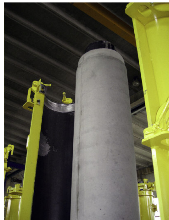
Rury betonowe odlewane z płynnego betonu dojrzewają w formach, dzięki czemu zapewniają niespotykane niskie tolerancje.
