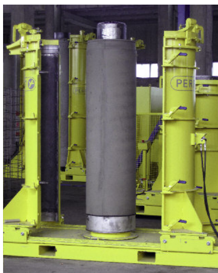
Na potrzeby konkretnych projektów są produkowane rury przeciskowe o długości 2 m i średnicy DN300.
