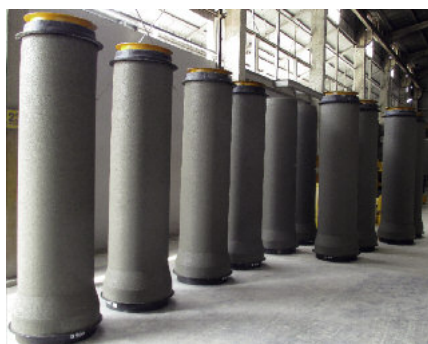
Rury betonowe z reguły dojrzewają w magazynie jeden dzień.
