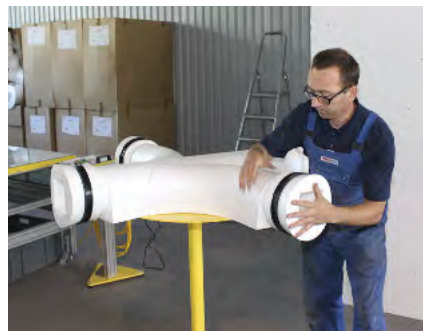
Finalnie doklejane są kształtki ze zintegrowanymi uszczelkami formujące przyłącza.
