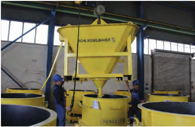
Zalewanie form za pomocą podajnika o poj. 2 m 3 od Schlüsselbauer Technology.
