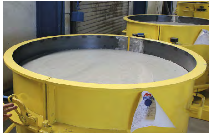
Wyroby dojrzewają do góry dnem, widoczny fragment to dno podstawy studni.
