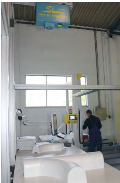
Bezблędny montaż kształtek zapewnia wskaźnik laserowy wyznaczający przebieg kanałów na stole montażowym.
