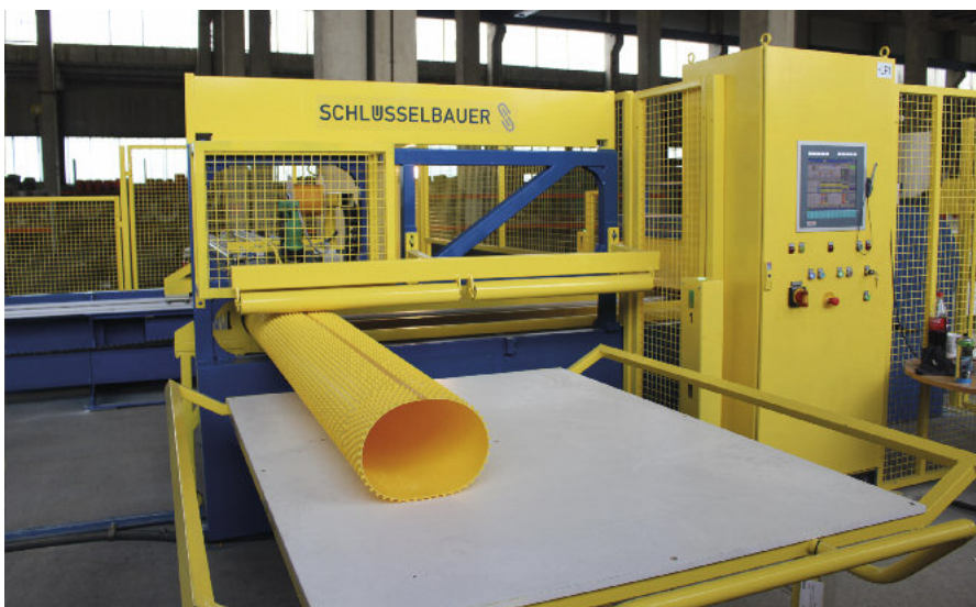
Wykładzina jest spawana w zautomatyzowanym procesie tworząc szczelny cylinder.
