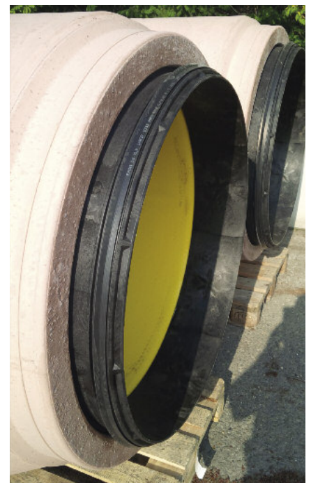
Wewnętrzna wykładzina jest odpowiednio formowana w obszarze kielicha, dzięki czemu zastosowanie konektora wtykowego nie zmienia przekroju wewnętrznego na całej długości rurociągu.
