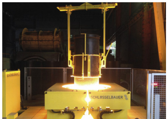
Termoplastycznie formowanie wykładziny Perfect na obu końcach rury celem późniejszego osadzenia konektora.
