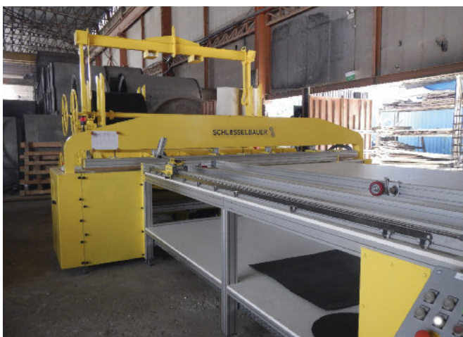
Przycinanie i automatyczne spawanie wykładziny Perfect dla określonej średnicy rury.
