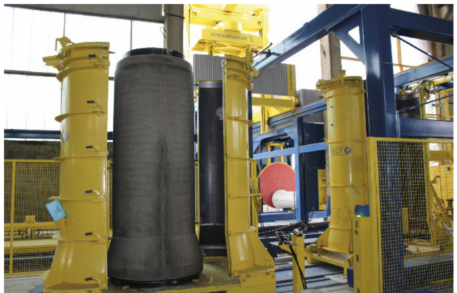
Robot z uniwersalnym chwytakiem odpowiednim dla wszystkich dostępnych średnic automatycznie podnosi rurę z rdzenia formy.
