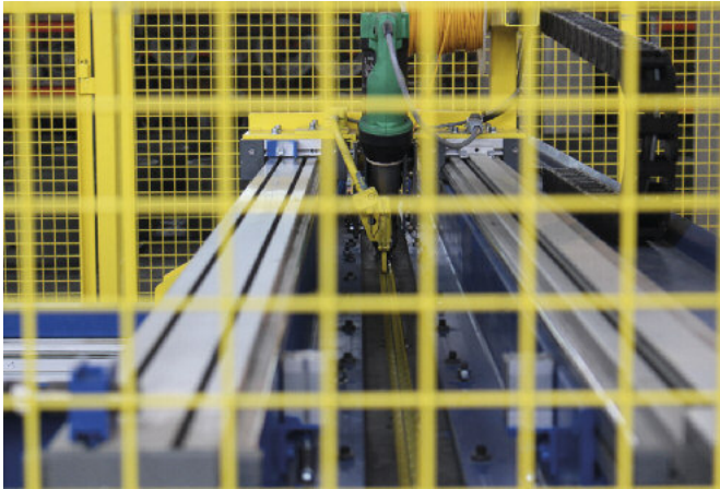
Automatyczny robot tworzy z wykładziny cylinder wykonując spaw z drutu PE. Obie krawędzie wykładziny zostają ze sobą bardzo trwale złączone.
