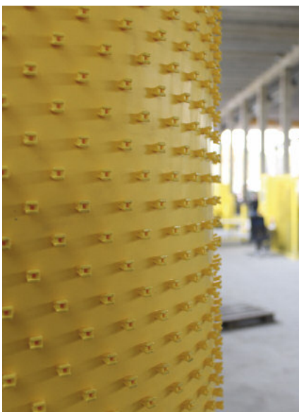
Mocne połączenie wewnętrznej powierzchni rury betonowej z wykładziną zapewniają gęsto rozmieszczone kotwy na jej tylnej stronie.
