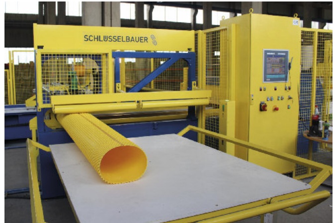
Automatyczny robot tworzy z wykładziny cylinder wykonując spaw z drutu PE. Obie krawędzie wykładziny zostają ze sobą bardzo trwale złączone.
