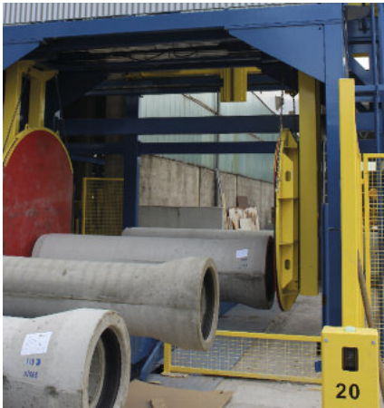
Integralną częścią procesu produkcji jest automatyczny test szczelności.
