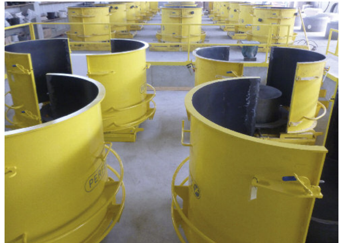
Łatwe w obsłudze formy stalowe do odlewania betonowych wyrobów z indywidualnymi konfiguracjami kinet.
