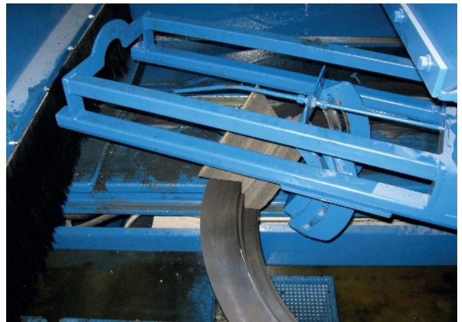
Oliwienie podkładu za pomocą gąbki eliminuje z procesu natrysk.
