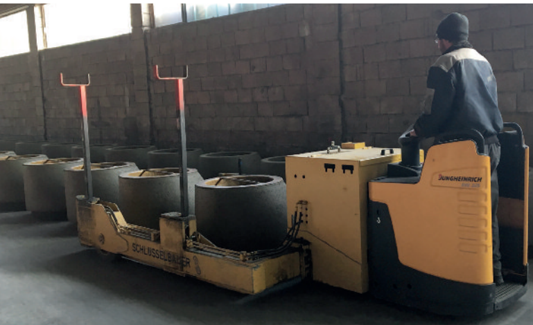
Transport wyrobu do strefy dojrzewania za pomocą wózka elektrycznego.
