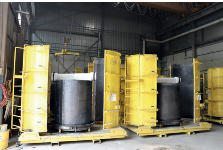
Les moules sont dotés d'une enveloppe en deux parties et peuvent être scindés en deux moitiés symétriques.
