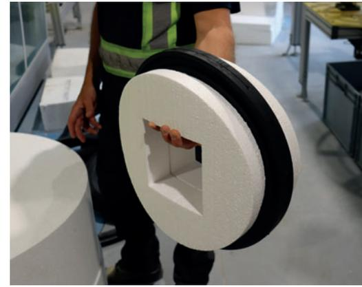
Los cuerpos de hueco individuales de las conexiones para tubos con junta integrada se producen con una sierra de alambre caliente adicional.
