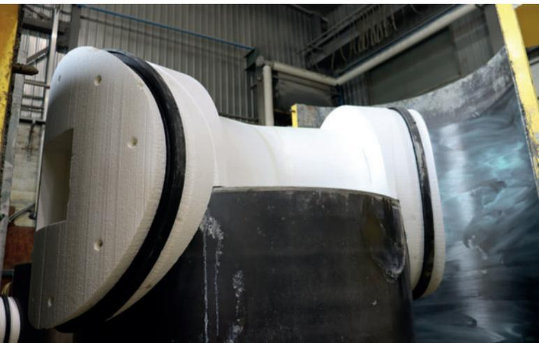
Los canales negativos fabricados se pueden fijar con tecnología magnética.
