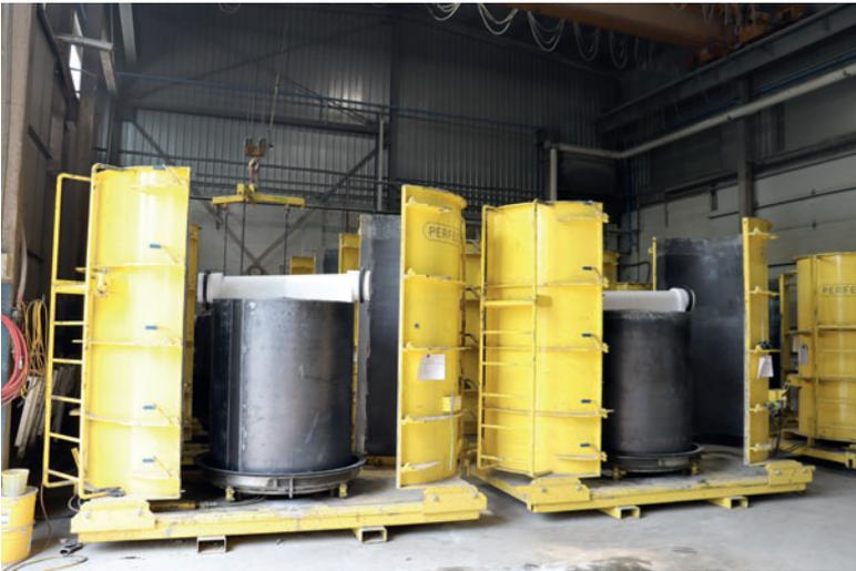
Los moldes presentan un revestimiento de dos piezas con el que se pueden desmontar de forma simétrica.
