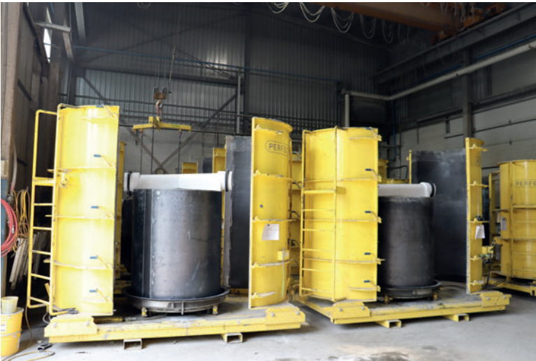
Die Formen haben einen zweiteiligen Formenmantel und lassen sich symmetrisch auseinanderziehen.
