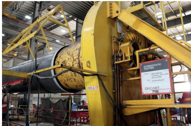
Стальные цилиндры, содержащие сварные торцевые кольца, проходят испытание на гидростатическую утечку
