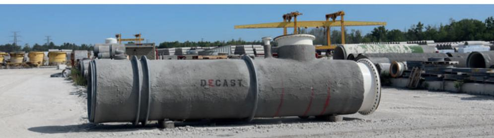
*С 2003 года компания Decast также выпускает бетонные напорные трубы для сетей питьевого водоснабжения*
