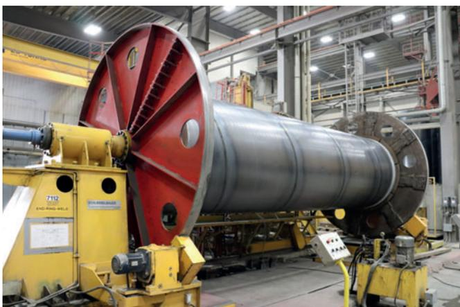
Затем концевые кольца привариваются по всей периферии стального цилиндра для соединения и герметизации
