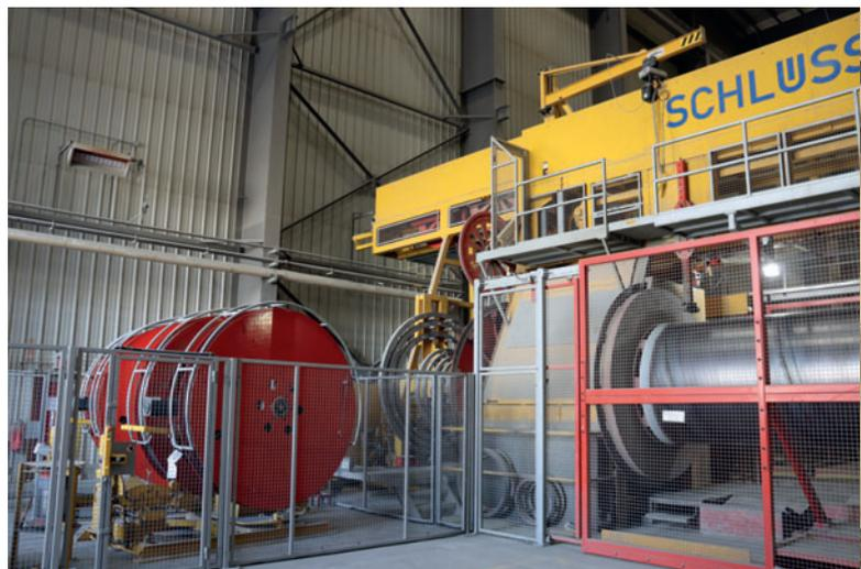
Высокоскоростная установка для предварительного напряжения Schlüsselbauer Technology была смонтирована после ввода всей линии в эксплуатацию
