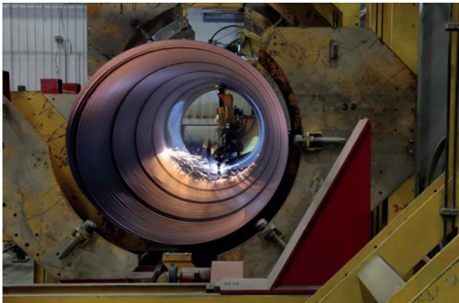
Сначала изготавливаются стальные цилиндры из листовой стали с бухты с использованием сварочных аппаратов со спиральным швом и формовочного оборудования
