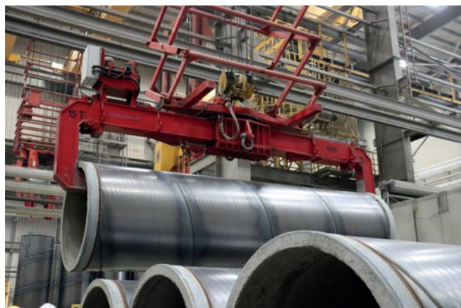
Надежная и быстрая погрузка-разгрузка с помощью телескопических зажимов
