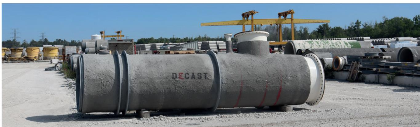
Depuis 2003, Decast produit également des tuyaux pression en béton pour la distribution d'eau potable
