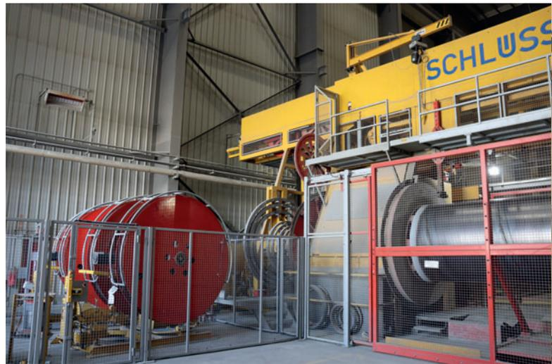
La machine de pré-tension à haute vitesse de Schlüsselbauer Technology a été intégrée dans la ligne de production comme une amélioration de processus essentielle.
