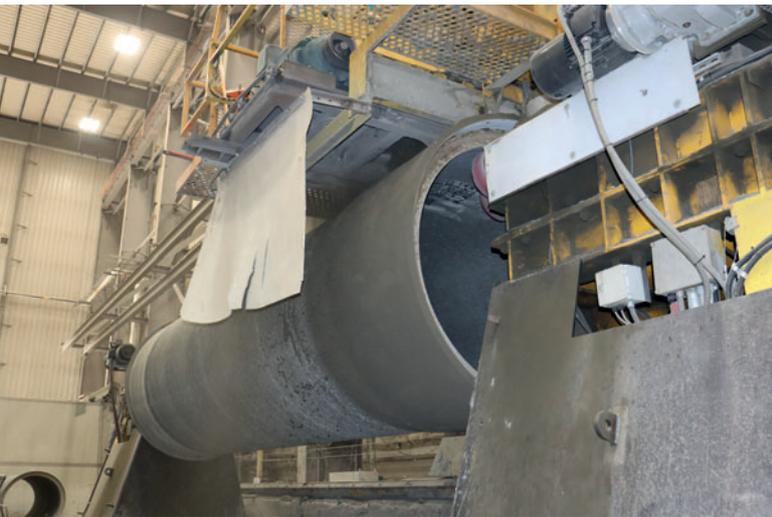
*L'installation de revêtement applique une couche de protection en mortier de béton sur le fil de pré-tension.*
