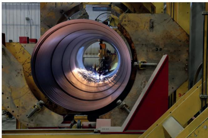
Tout d'abord, un cylindre en acier sans fin est formé à partir d'une tôle d'acier provenant d'une bobine à l'aide d'appareils de soudage à cordon en spirale et de matériel de moulage.
