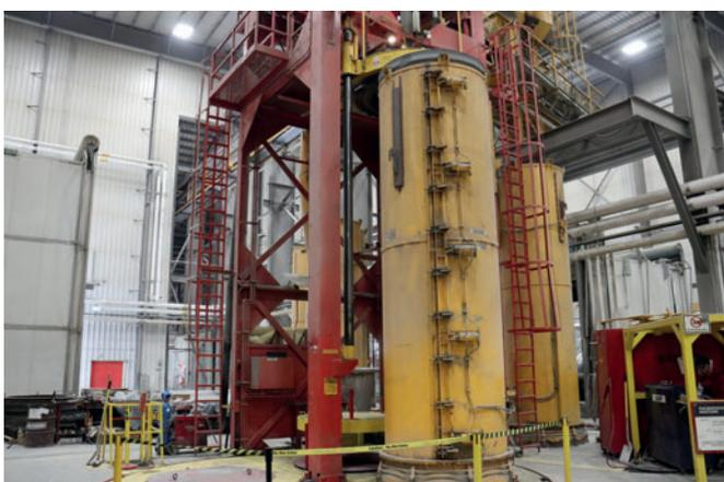
Soldadora de cabeza prensadora para aplicar el núcleo de hormigón interior
