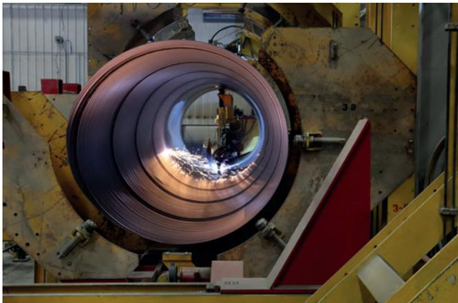
En primer lugar, se fabrica un cilindro de acero sinfín a partir de chapa de acero de bobina utilizando soldadores en espiral y equipos de moldeo.
