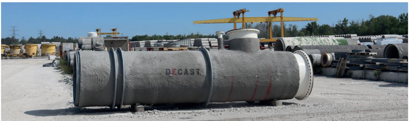
Desde 2003, Decast también produce tubos de presión de hormigón para transportar agua potable.
