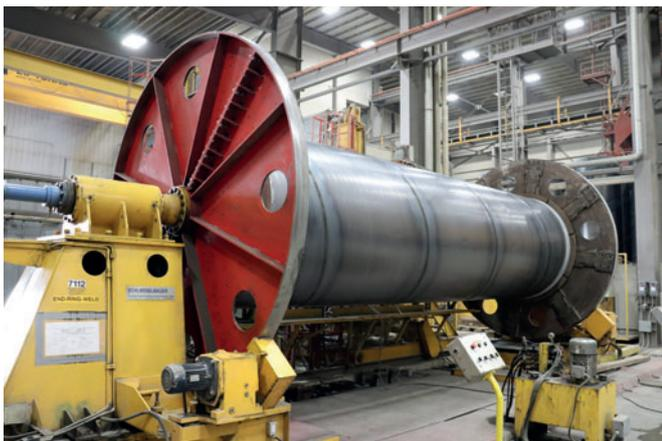
A continuación, los anillos tutores se sueldan en todo el contorno del cilindro de acero, de manera que queden unidos con firmeza y sellados.
