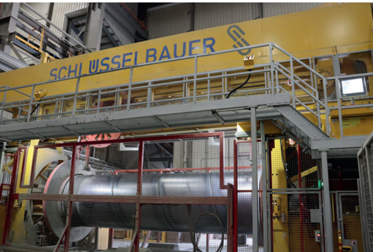
Die Hochgeschwindigkeits-Vorspanmaschine von Schlüsselbauer Technology wurde nachträglich in die Produktionslinie integriert.
