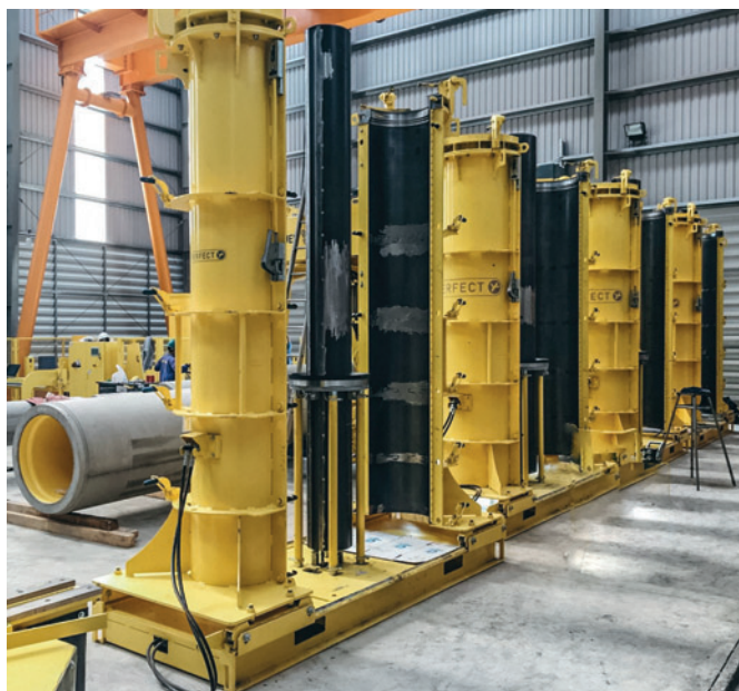
Łatwe u obsłudze formy z rodziny Perfect Forming Technology od Schlüsselbauer w zakładzie firmy Phnom Penh Precast Plants, Kambodża.
