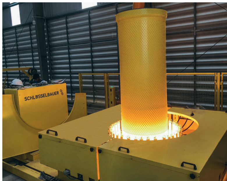
Termoplastyczne formowanie cylindra jest kluczowym krokiem w procesie produkcji rur Perfect Pipe.
