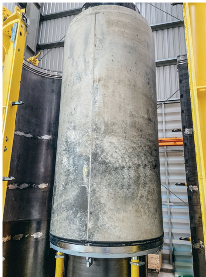
Perfect Jacking Pipe - rura przeciskowa dojrzała już po paru godzinach od zalania formy.
