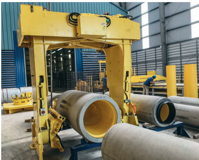
Phnom Penh Precast Plants stosuje technologię Perfect Pipe w zakresie średnic do DN700.
