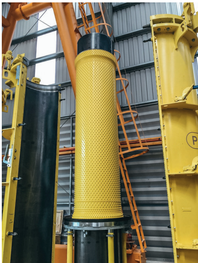
Okładzina Perfect Liner umieszczona na rdzeniu kurczliwym.
