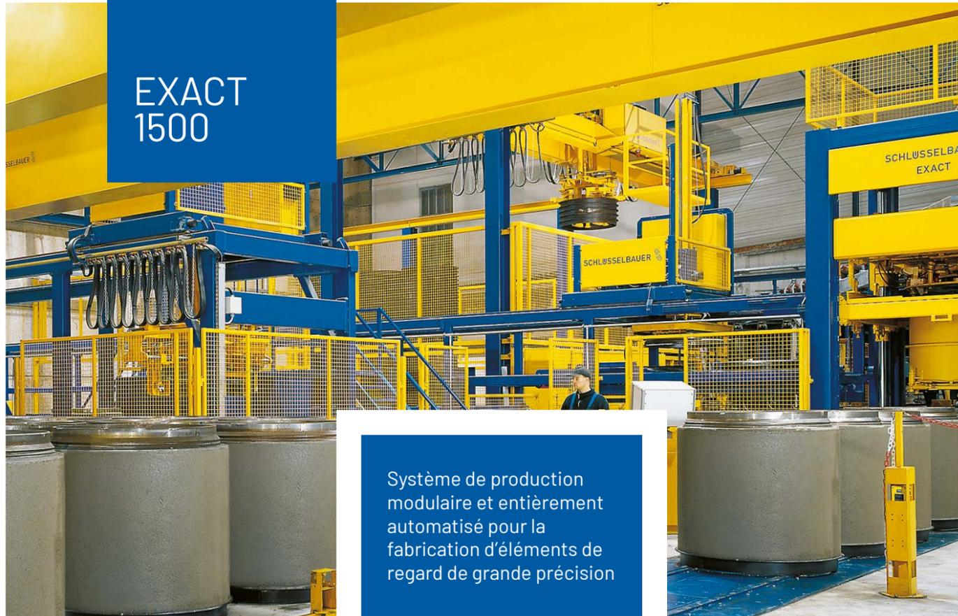
Système de production modulaire et entièrement automatisé pour la fabrication d'éléments de regard de grande précision
