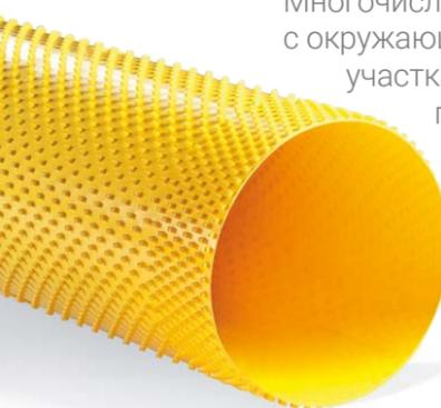
Прочность на разрыв каждого отдельного анкера составляет более 250 Н, а футеровка в целом выдерживает постоянное давление грунтовых вод до 1,5 бар. Даже при сильных температурных колебаниях футеровка не отделяется от бетона. При различных региональных, нормативных или специальных требованиях для отдельных проектов толщина стенок футеровки может составлять от 1,65 до 3 мм.
