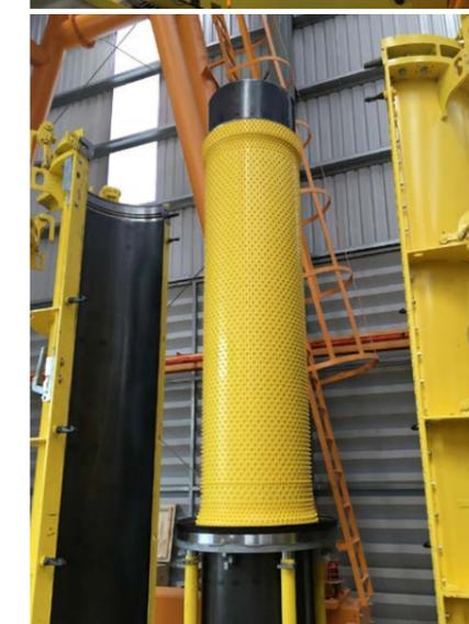
Благодаря инновациям в бетонной технологии, а также сочетанию бетона с футеровкой из ПЭВП, бетон, как проверенный многими годами стройматериал, может обеспечивать надежный и эффективный отвод сточных вод в широком диапазоне применения с помощью технологии **PERFECT PIPE**.
