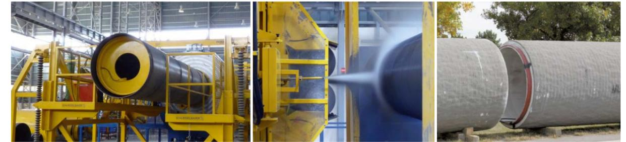
Los tubos de hormigón pretensado con cilindro de acero (PCCP) se usan desde mediados del siglo XX en todos los países industriales, sobre todo en Europa y América del Norte, para conducciones de agua y de agua potable.
