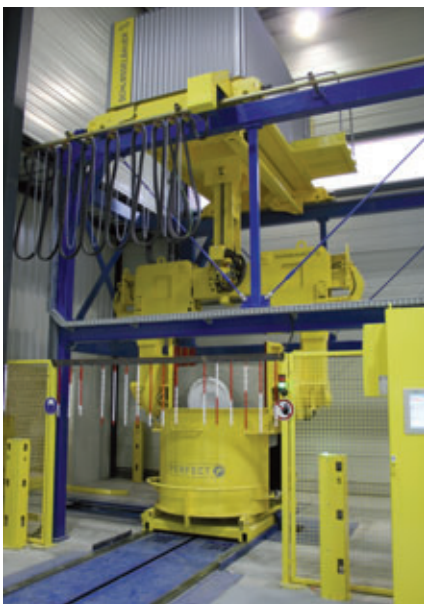
Les fonds durcis sont démoulés au moyen de la pince du retourneur.
