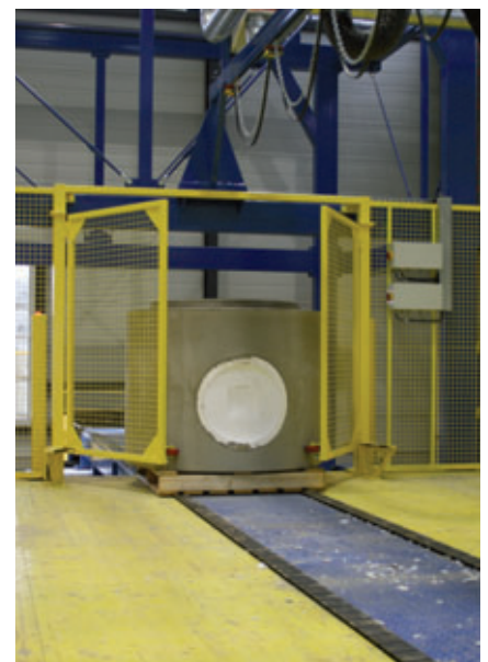
...avant d'être déposés sur le convoyeur de la zone de démoulage du polystyrène, dernière station de leur parcours.
