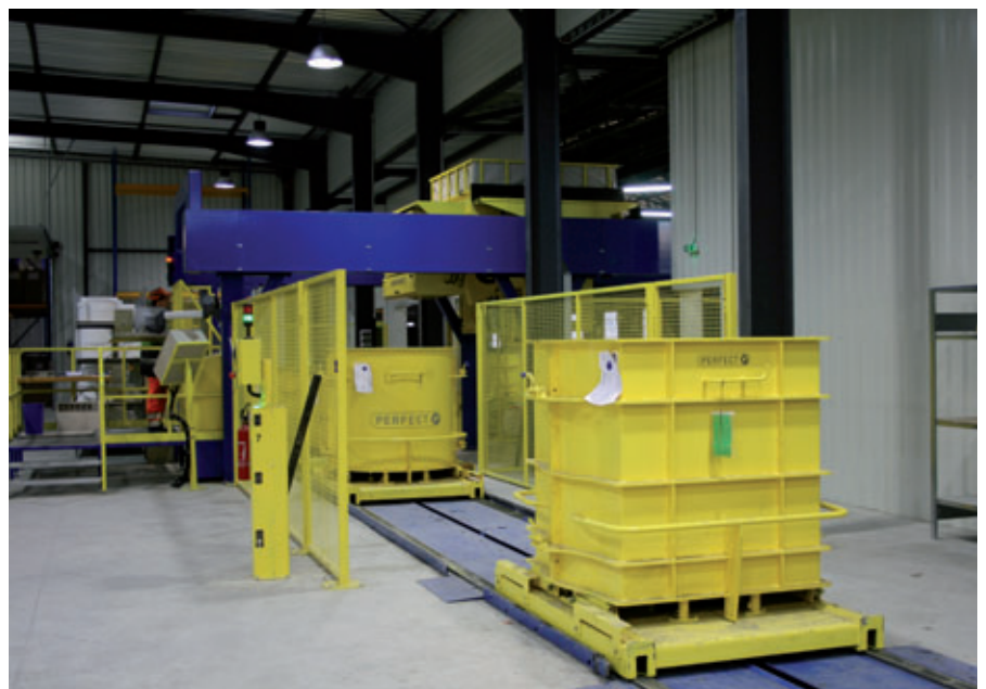
Les moules préparés partent automatiquement à la station de coulage
