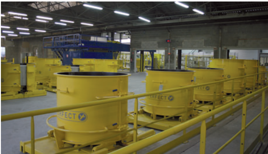
Les moules juste remplis sont évacués au moyen d'un chariot de transport et placés sur le parc de séchage
