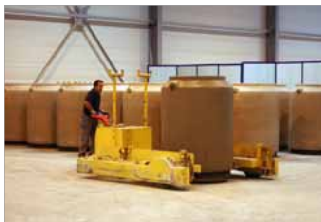
Un chariot de transport apporte les éléments de regards sur l'aire de séchage...
