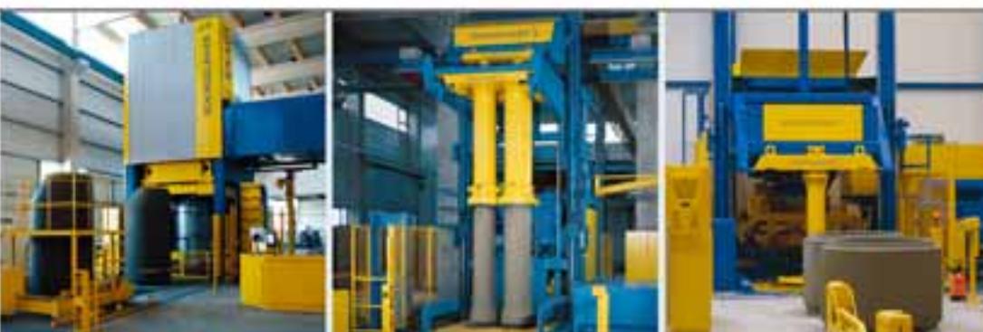
Installations de production pour tuyaux, éléments de regards et produits spéciaux
