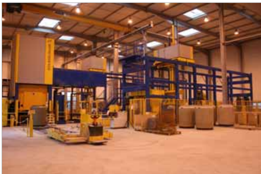
Une installation EXACT de fabrication de regards a récemment été mise en service chez Plattard à Villefranche, France.
