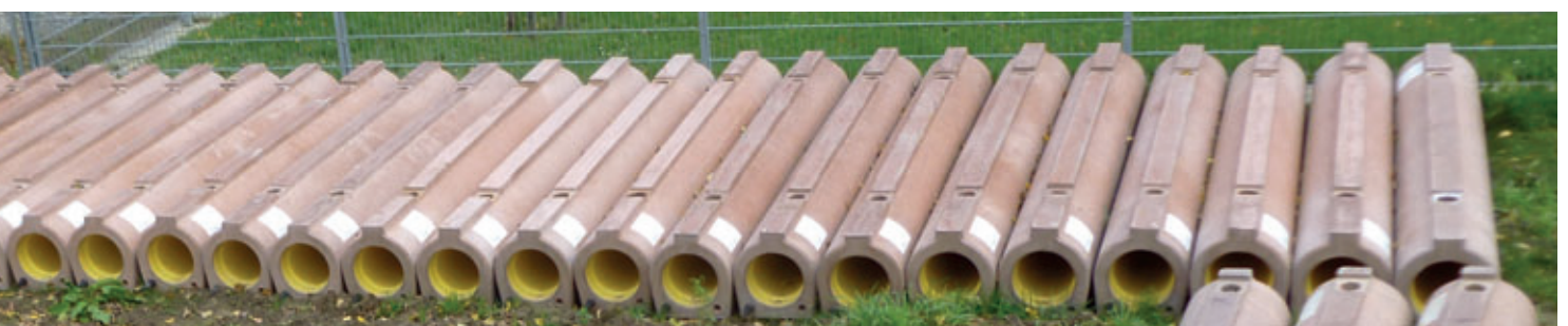
Stockage standard de tuyaux Perfect diamètre 250 à Endingen am Kaiserstuhl (Allemagne).
