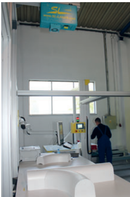
Les contrôles de l'ajustement du positionnement de chaque pièce sont assurés par un laser placé au-dessus de la table de travail qui projette sur celle-ci en permanence tous les contours de la cunette.
