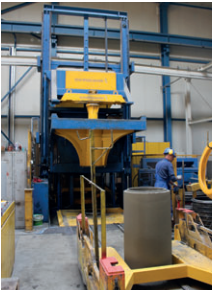
Matbet utilise depuis 2005 une machine de fabrication de type Magic de Schlüsselbauer Technology.
