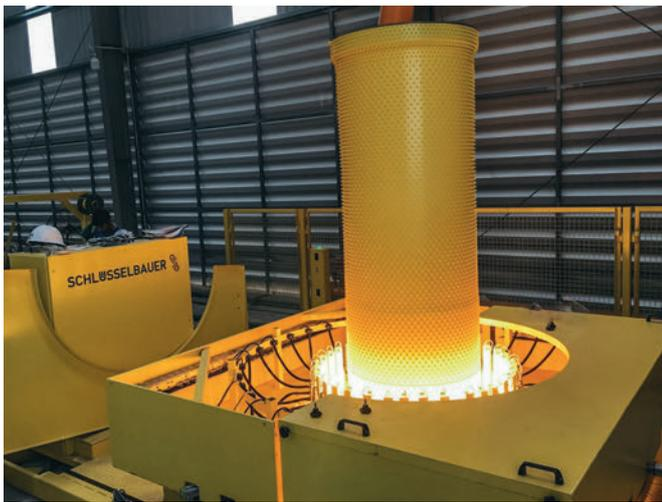
Moldeo termoplástico del revestimiento para manguito interior
