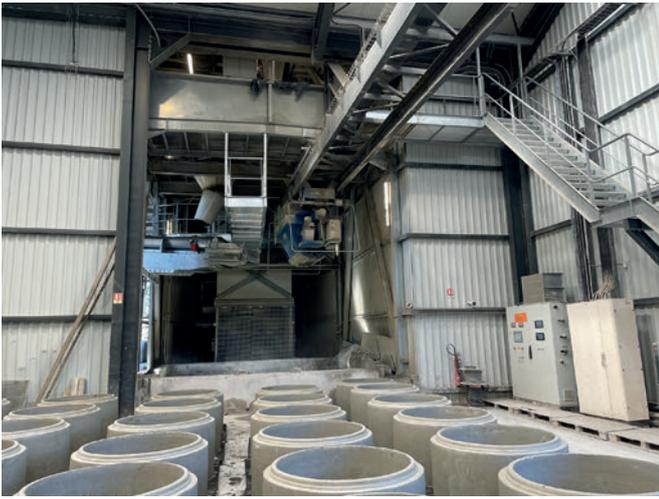
*La instalación de mezcla Teka produce el hormigón para todas las áreas de producción*
