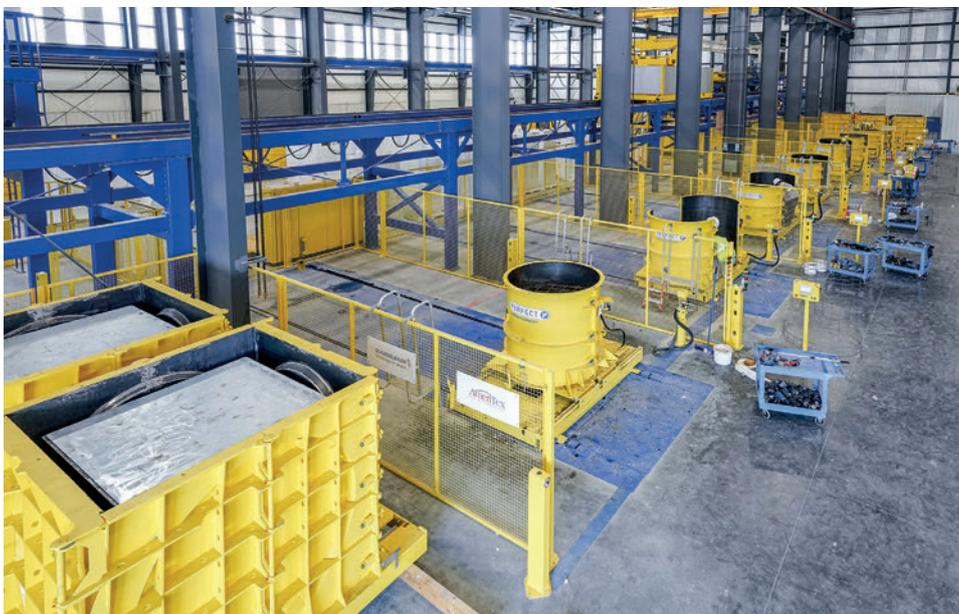
*Los varios puestos de equipamiento para moldes de vaciado en húmedo garantizan que no se produzcan nunca retrasos en el sistema completo a pesar de los distintos tiempos de equipamiento.*
