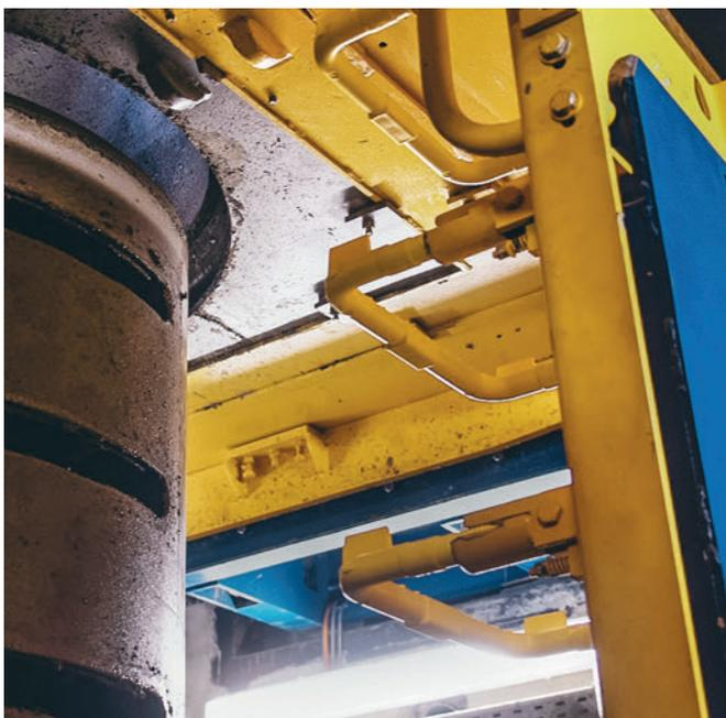
*Al igual que los anclajes, los estribos también se transfieren de forma automática a la máquina y se integran directamente en el hormigón fresco del componente que corresponda.*
