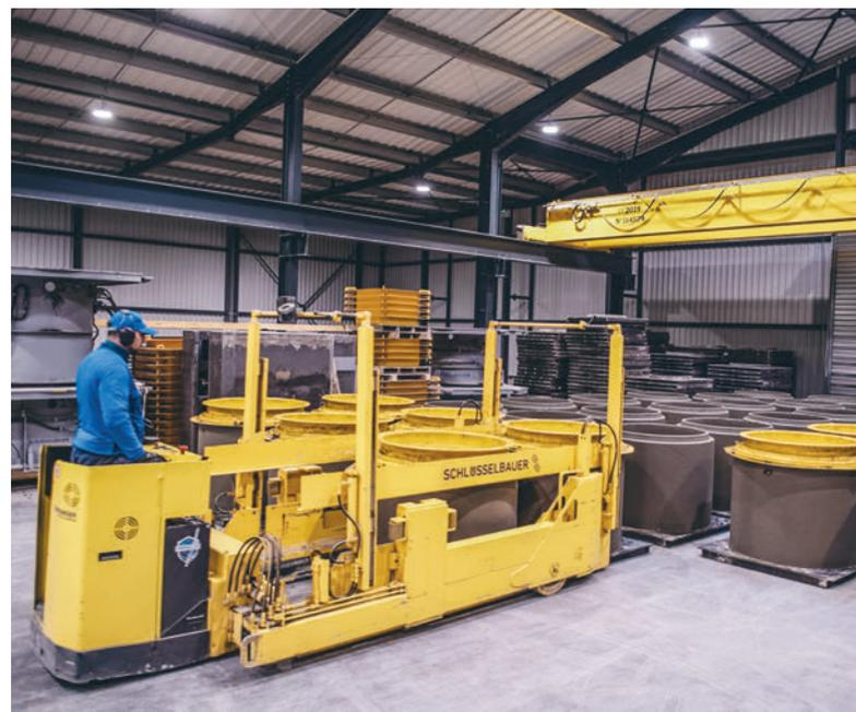
*Los productos se transportan con un carro eléctrico a la zona de endurecimiento y, después, a la instalación de paletizado.*
