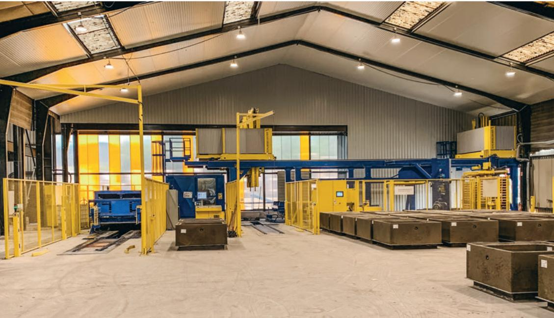
*La instalación de paletizado se ocupa de numerosos pasos de trabajo de forma totalmente automatizada, tanto por lo que a los encofrados inferiores como a los productos de hormigón se refiere.*
