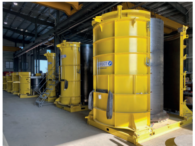
El sistema de moldes Perfect Forming Technology para el procesamiento de hormigón autocompactante es un elemento esencial para el proceso de producción de Perfect Pipe.
