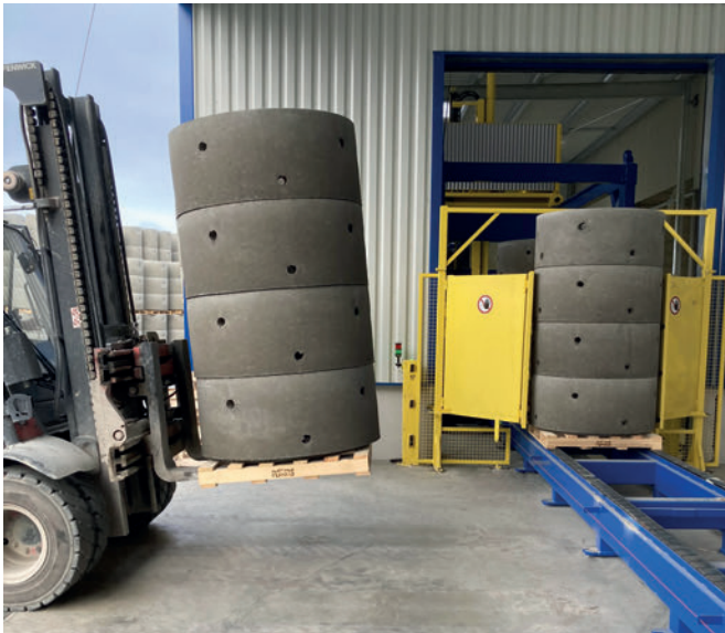
El transporte de productos fabricados apilados en palés. Se ha mejorado la colocación de la cinta transportadora: a lo largo de la nave bajo una marquesina en una zona protegida junto al carril y la zona del almacén exterior.
