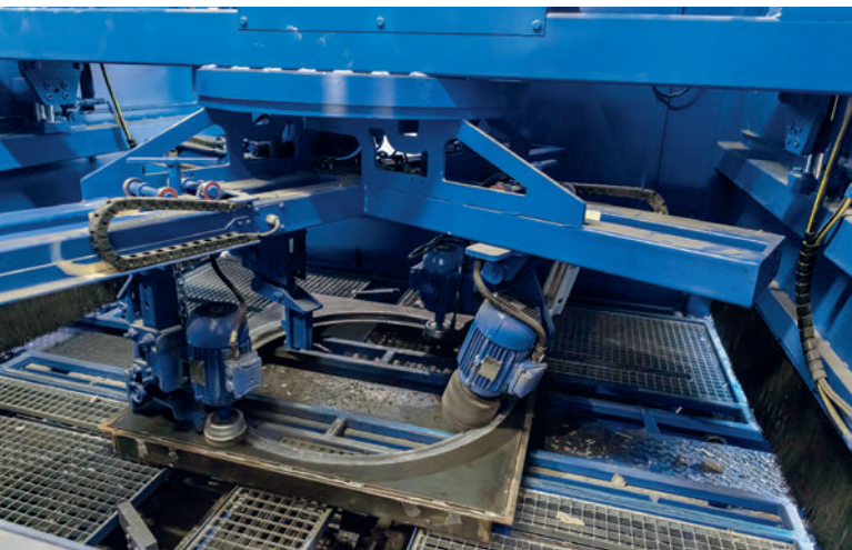
Unidad de limpieza para el encofrado inferior, junto con el engrasado sin pulverización: un clásico de los sistemas de paletización de Schlüsselbauer.
