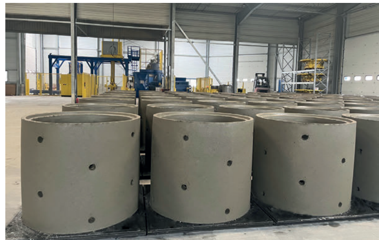
Ubicación idónea de la zona de endurecimiento (en este caso con anillos para pozos con perforaciones sépticas) en la zona de la nave entre la máquina de producción y la paletización.
