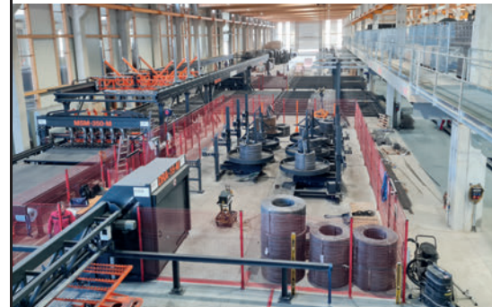
Máquinas soldadoras de mallas para elementos prefabricados de hormigón, marcos y mallas específicas del cliente
