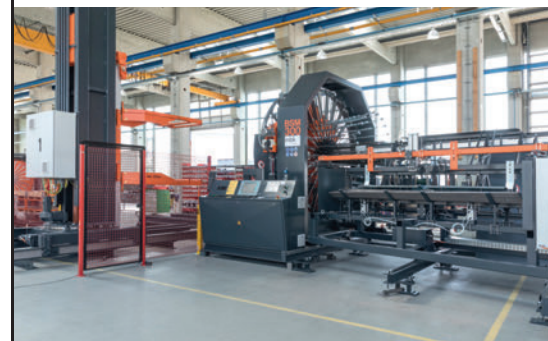
Máquinas soldadoras de armaduras para pozos de registro y tubos de hormigón
