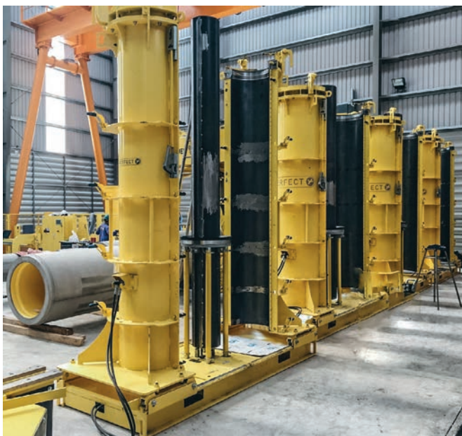
Moldes de fácil manejo de la categoría Perfect Forming Technology de Schlüsselbauer en la producción de Phnom Penh Precast en Camboya
