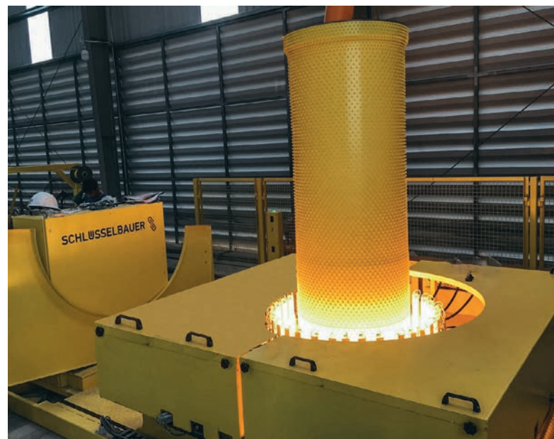
El moldeo termoplástico del cilindro de liner es un paso fundamental en la fabricación de Perfect Pipe.
