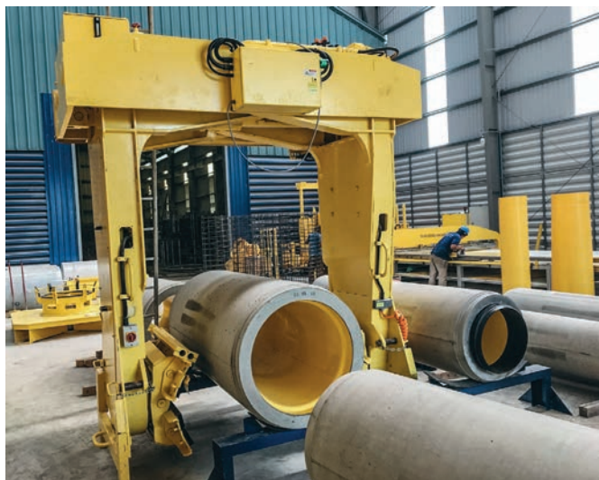
Phnom Penh Precast domina la técnica Perfect Pipe en anchos nominales no accesibles de hasta DN 700.
