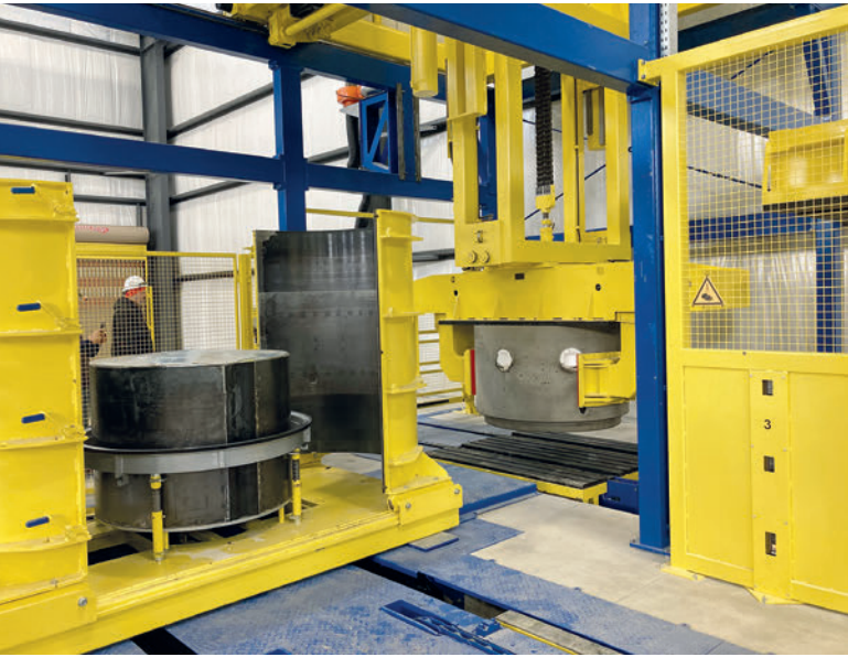
Desencofrado de las bases para pozos automático y cronometrado de forma optimizada
