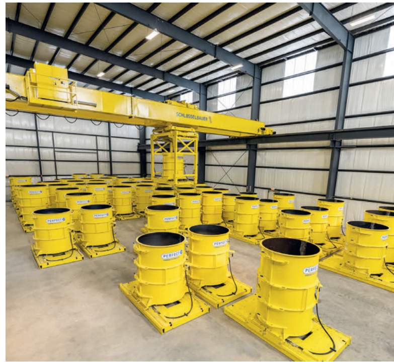
Reducción de los costes y de los riesgos en la zona de endurecimiento gracias a la administración automática de los moldes
