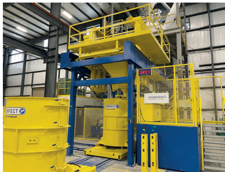
Al equipar los moldes según la división del trabajo, estos están siempre disponibles para el llenado con HAC.
