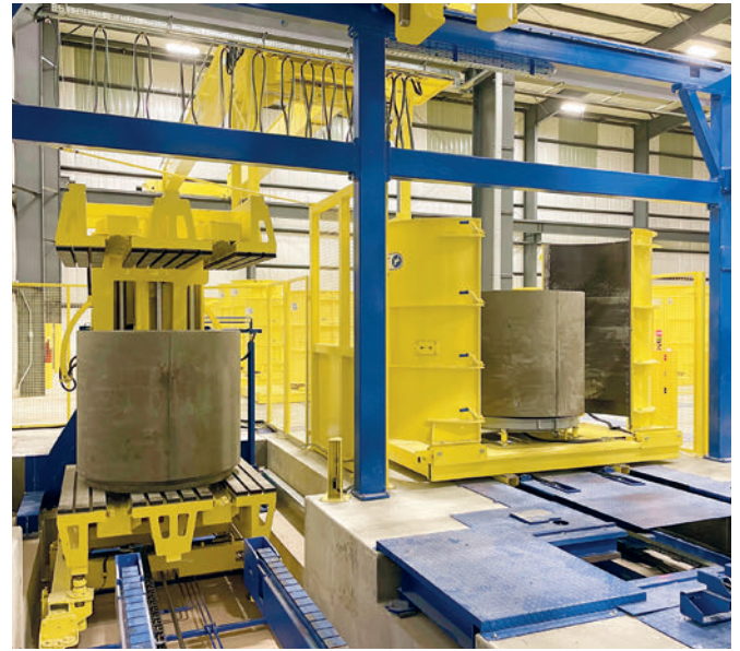
Si es preciso, los productos desencofrados se giran 180 grados de forma automática y, por tanto, cuidadosa.
