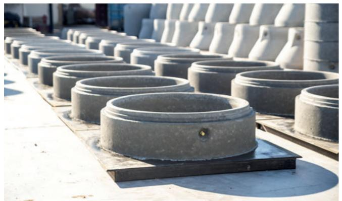
Los anclajes de cabezal esférico firmemente integrados en el hormigón constituyen la base para una manipulación segura hasta el traslado al lugar de obra. © Vojtěch Peša
