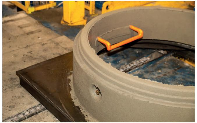
Además de los anclajes de elevación, también se transfieren estribos a la máquina y se integran en el componente de forma automática e independiente del tiempo de ciclo.
