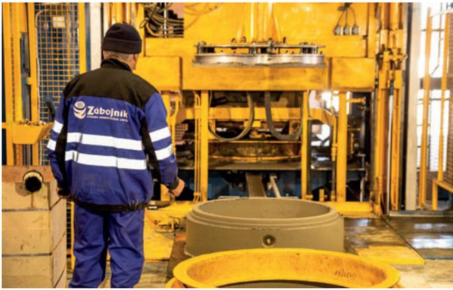
Los anillos de pozos se producen, por lo general, con dos grosores de pared y tres alturas de construcción.
