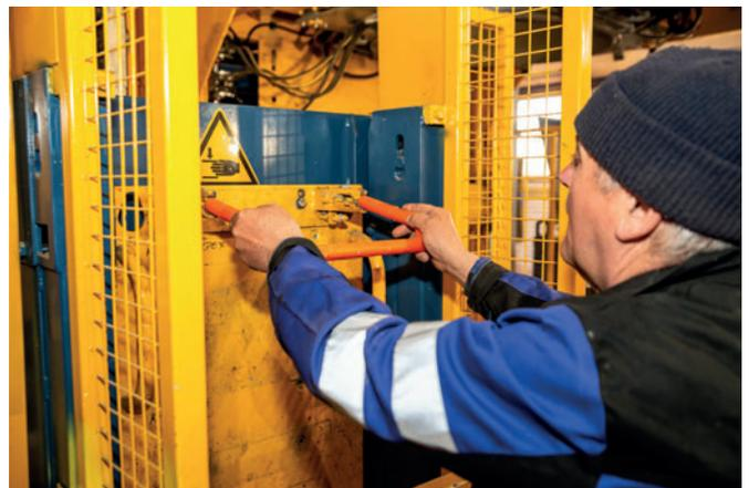
El operario de la máquina prepara los estribos necesarios para la transferencia automática a la máquina.
