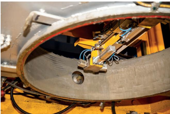
Un aspecto decisivo para Zábojník s.r.o. en lo que respecta a la automatización de instalaciones: la transferencia automática de los anclajes de cabezal esférico a la unidad de moldeo. © Vojtěch Peša
