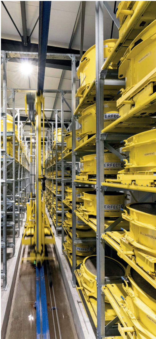
Almacén con estanterías como área de solidificación eficiente y compacta para productos endurecidos por encofrado
